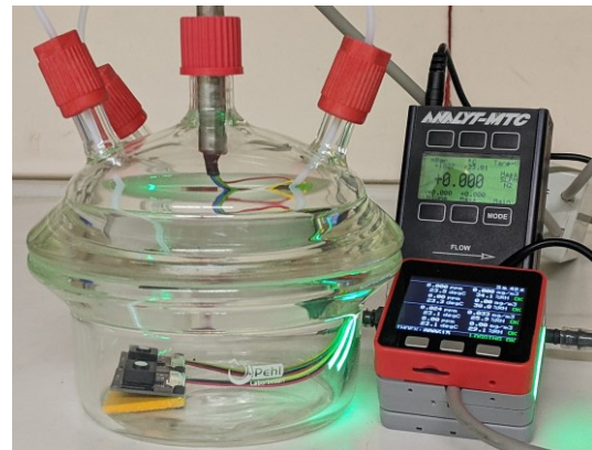
Abb. 4: H_2S -Messsystem mit Messkammer, Durchflussmesser und Datenlogger Fig. 4: H_2S measuring system with sensor chamber, flow meter and data logger
