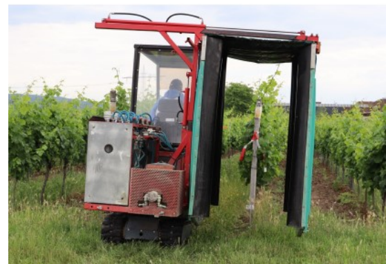
Abb.1: Parzellen-Sprühgerät für die Applikation der Formulierung im Rahmen der Mittelprüfungen.
