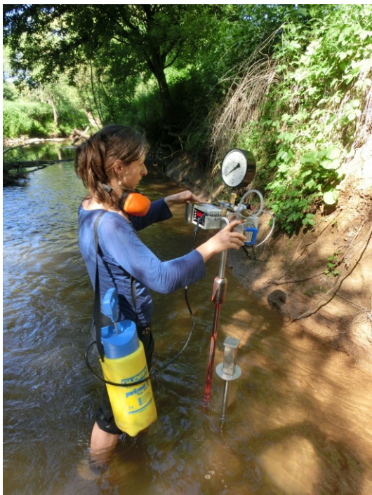
Abb. 2: Messung der Kolmation: Erfassung der Durchlässigkeit der Gewässersohle Fig. 2: Measurement of colmation: assessment of the permeability of the water bed
