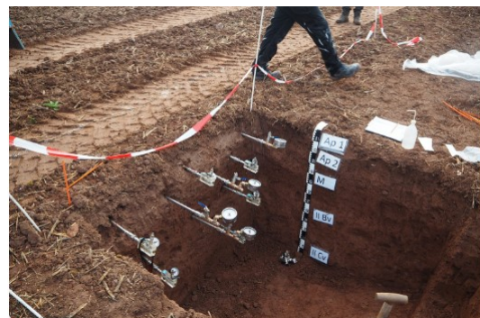
Abb. 1: Sensoranordnung für den Befahrbarkeitstest
