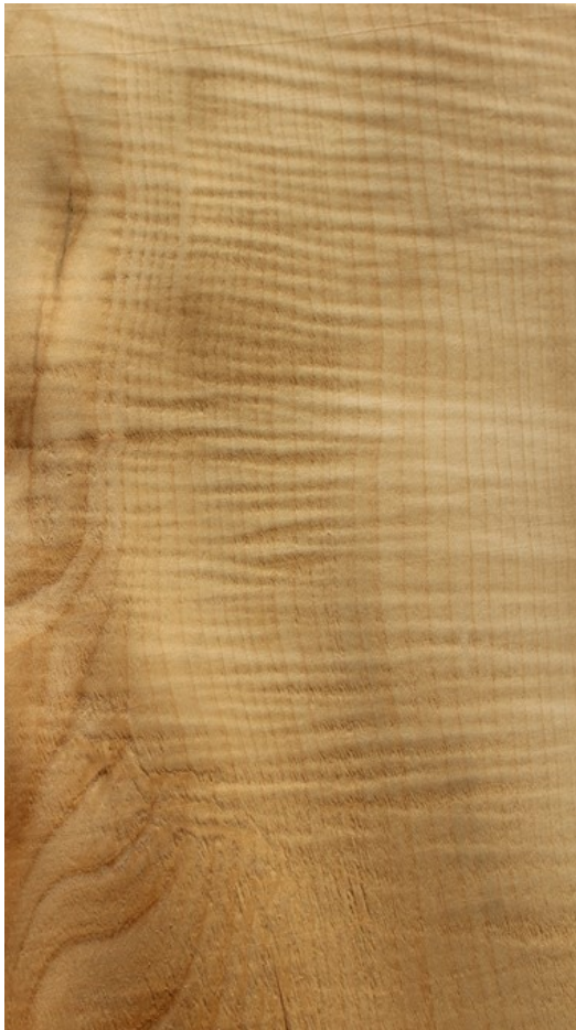
Abb 2: Furnierprobe von Riegelahorn-Holz. Der wellenförmige Verlauf der Holzfasern verursacht die Querstreifung des Furniers. Fig. 2: Veneer sample of wavy grain maple wood. The wavy course of the wood fibres causes the transverse banding of the veneer.
