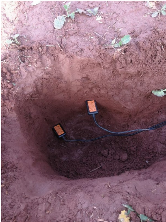
Abb. 2: LoRa-WAN- fähige Bodenfeuchtesensoren innerhalb der Ackerfläche
